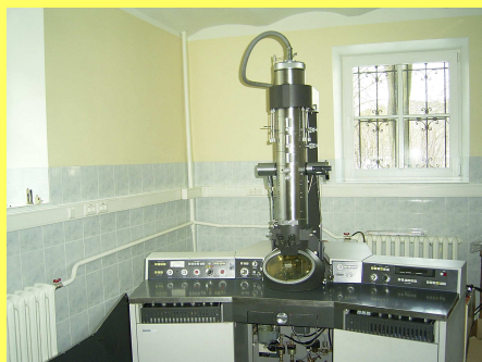
Transmisijas elektronu mikroskops Philips 301. Palielinājums 200 000 reižu. Mikroskopa izšķirtspēja 1 \times 10^{-10} m. Rāda šūnu sastāvdaļas šķērs griezumā.
